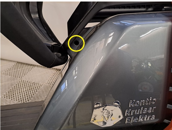
Irrota vasenta kylkipaneelia kiinni pitävä kiinnitysruuvi. (ristipäämeisseli ph2).
